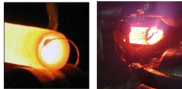
Рисунок 1 – Образования кольцевого отслоения (облой) на гильзе
